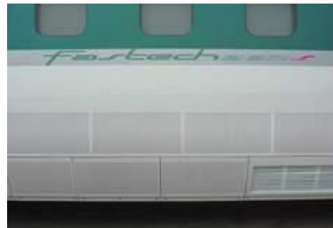
側スカート部
