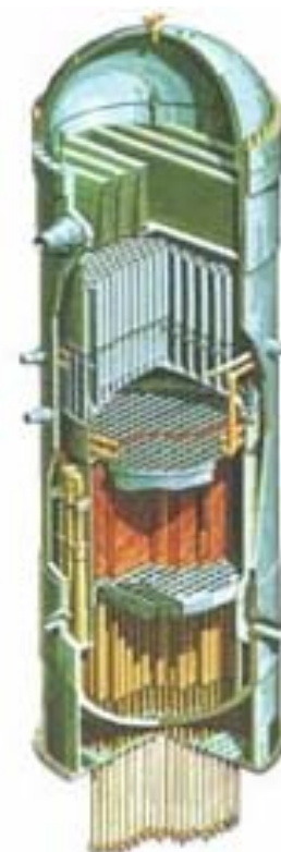
原子炉容器と 炉内構造物
