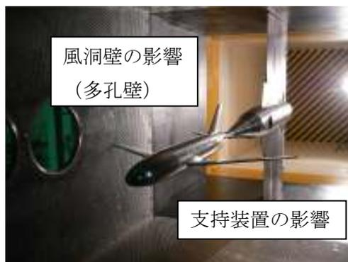
図 1 風洞内に支持された模型
